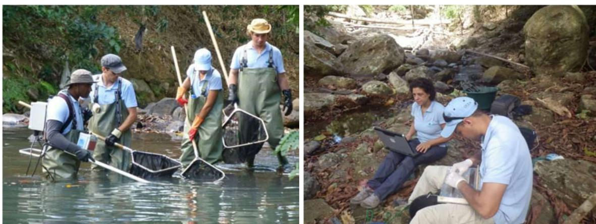
Figure 5 - Pêche électrique à pied sur un cours d'eau de Mayotte (gauche), Identification et saisie informatique des captures in-situ- droite) - OCEA, 2014.
